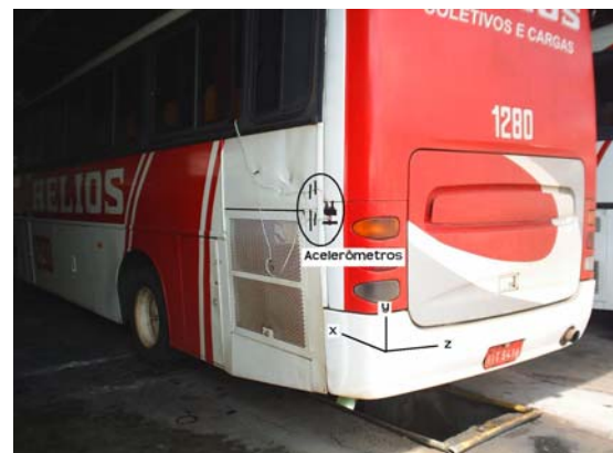
Figura 25 – Local de fixação dos microacelerômetros
