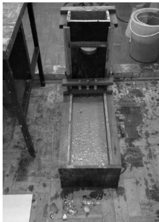
Figura 3: Ensaio da Caixa L do CAA Fonte: Fochs (2011).
