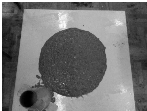
Figura 1: Ensaio de espalhamento de um CAA Fonte: Fochs (2011).
