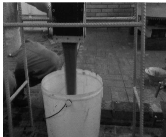
Figura 2: Ensaio Funil V do CAA Fonte: Fochs (2011).
