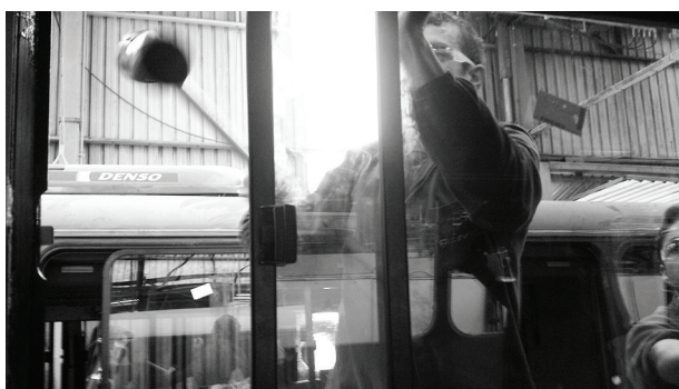
Figura 7 - Pancadas com martelo de borracha Fonte: Comil (2010).
