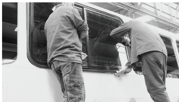
Figura 5 - Janela sendo posicionada para montagem Fonte: Comil (2010).
