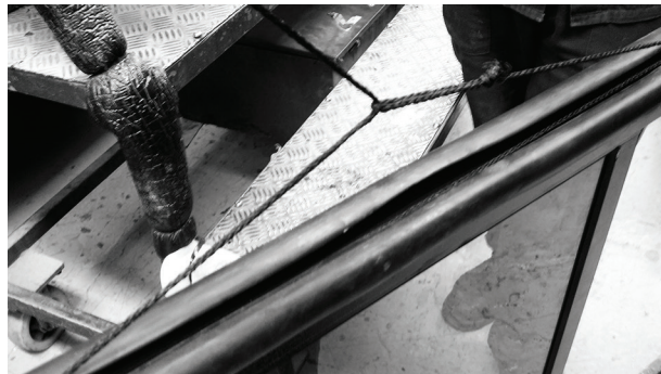
Figura 3 - Envolvimento do cordão no perfil de borracha Fonte: Comil (2010).
