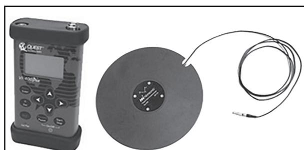
Figura 1 - Medidor VI400-Pro e *seat pad* utilizados nas medições
