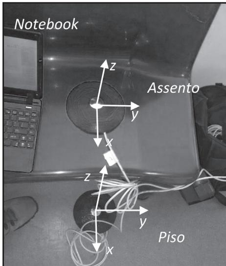
Figura 15 - *Seat pad* posicionado no assento e piso do banco central do aeromóvel. Eixos coordenados indicam orientação final dos acelerômetros
