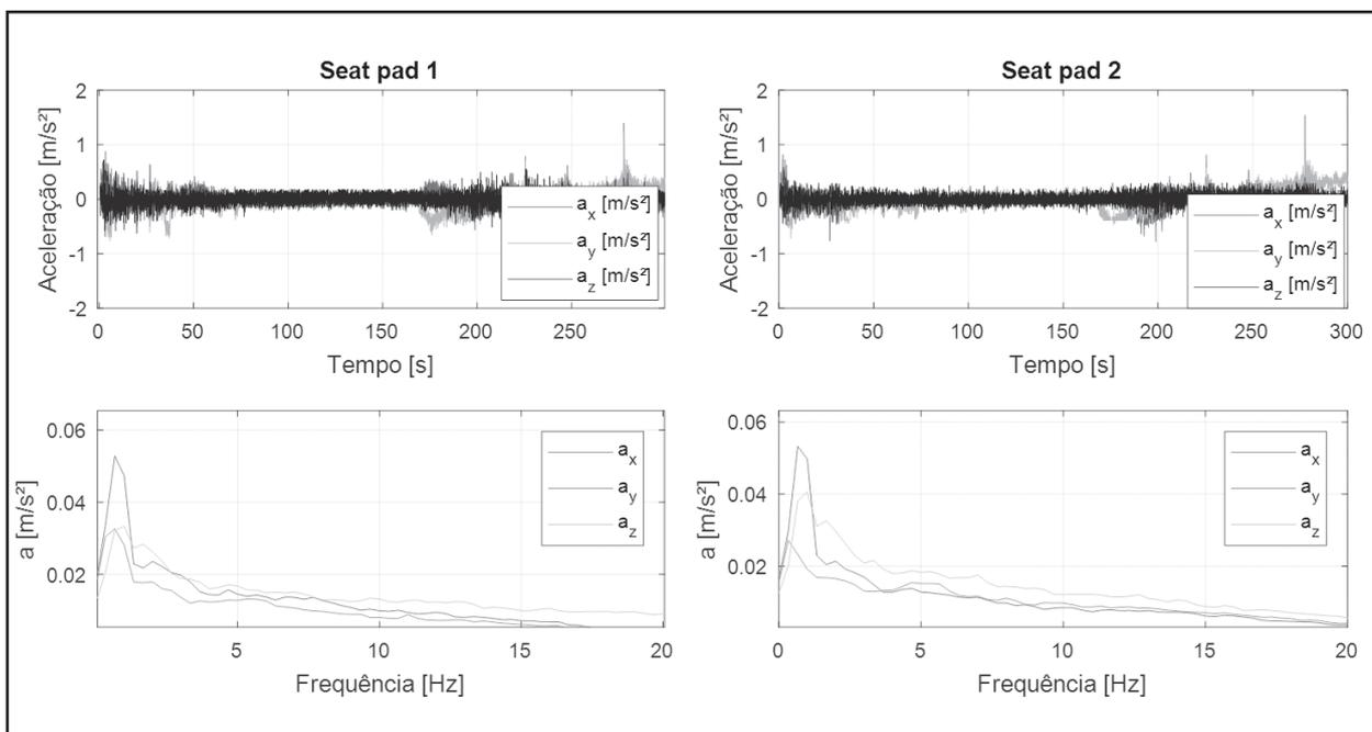
Figura 16 - Sinais de aceleração medidos pelos dois *seat pads* e os respectivos espectros de frequência
