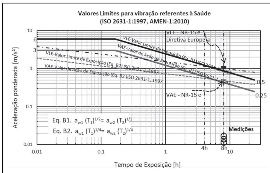
Figura 12 - Valores limites para vibração referentes à Saúde para todas as medições. Círculos representam as medições
