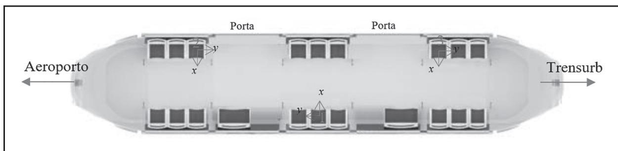
Figura 4 - Vista superior dos assentos no modelo A100 e posições de medição
