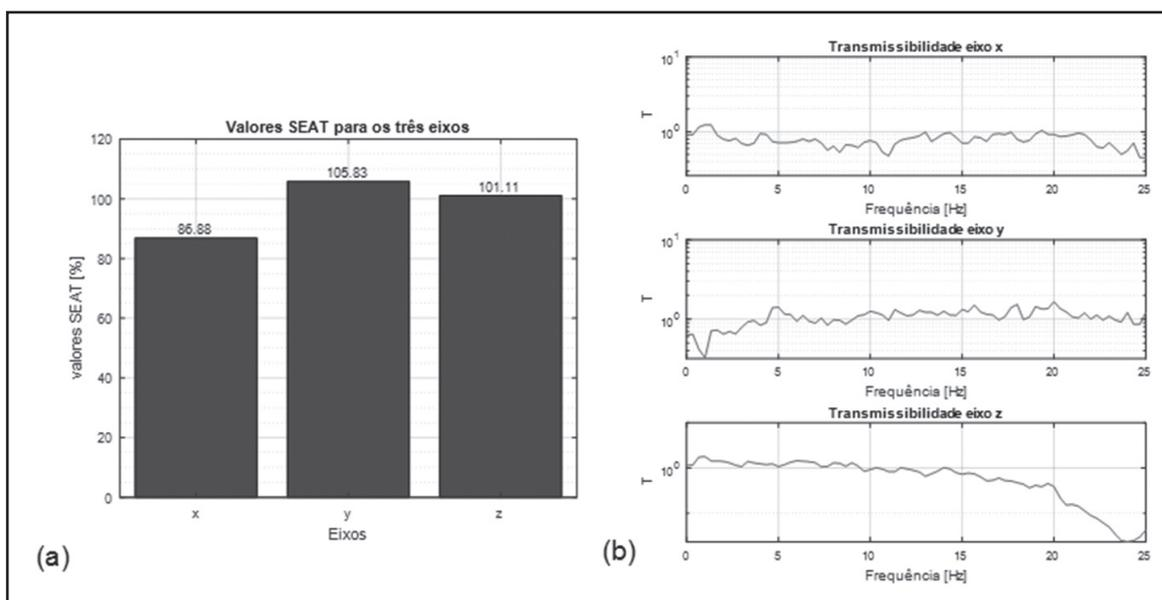
Figura 17 - (a) Valores do índice SEAT para cada um dos três (3) eixos na posição um (1) e (b) Transmissibilidades de aceleração
