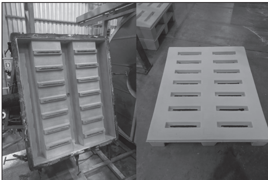
Figura 5 – Interior do molde, utilizado para a fabricação de palete rotomoldado e produto, após extração
