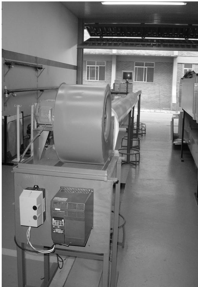
Figura 01 Túnel de vento
