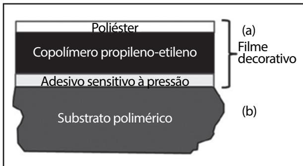
Figura 6 - Revestimento sobre um material polimérico
